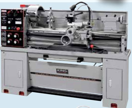
• Comprend mandrin 6"-3 mors, mandrin 8"-4 mors, engrenages de remplacement, porte-outil à changement rapide, lunette fixe, lunette mobile, plateau de tournage 12" DI-4, système de refroidissement, garde d'écalbouissement pleine longueur, cadran indicateur pour pas de vis, 2 pointes fixe MT#3, manchon JT#5-MT#3, plateau, coffre d'outils, halogène, clés de mandrin, clés hexagonales et cabinet fermé (avec frein à pied incorporé)
